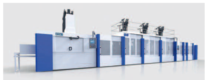
In ihrer ganzen reduzierten Länge: die neu entwickelte ‚BoreHone‘-Anlage für den (patentierten und) verkürzten Grob/Nagel-Prozess zum Feinbearbeiten von Zylinder-Kurbelgehäusen.
