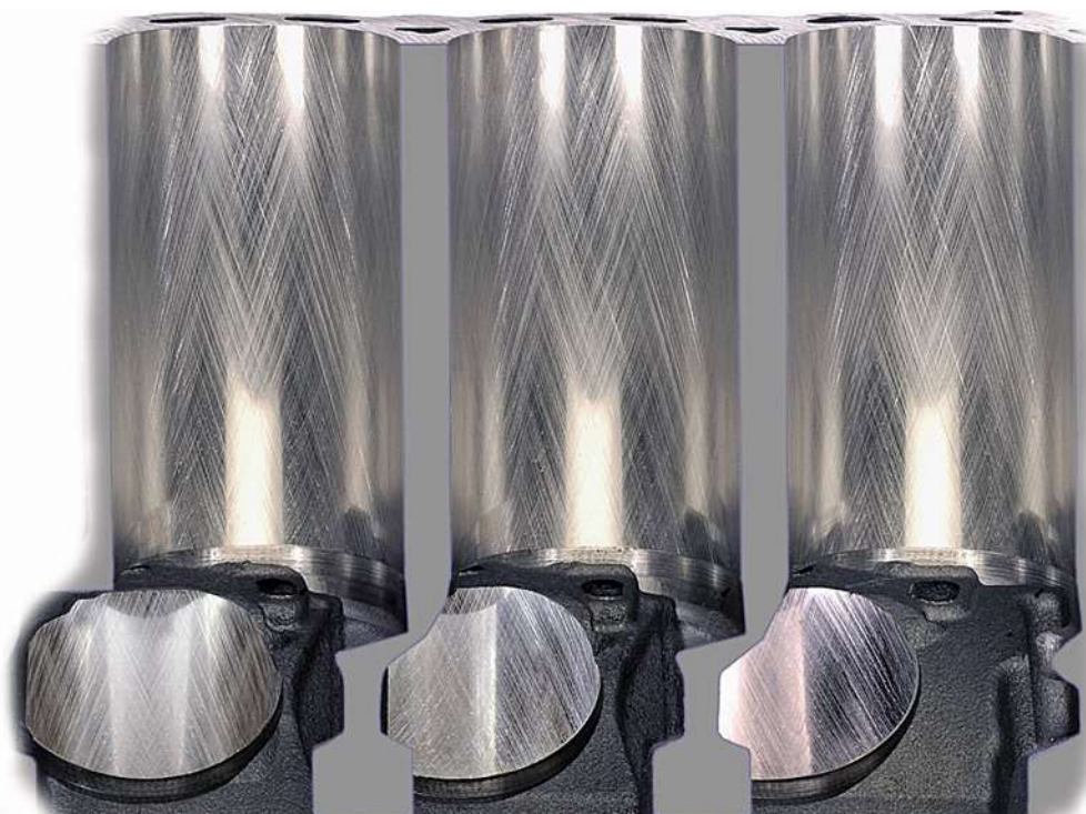
Bild 1: Zylinderbohrungen nach dem Spiralgleithonen.
